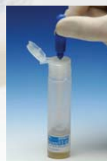
Open the top lid and inject ST-SSP.
